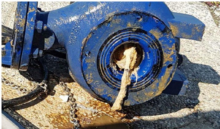
Slika 2: Zamašena črpalka zaradi krp, vlažilnih robčkov ipd.
