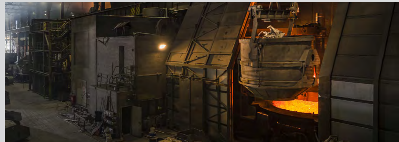
Odvečna toplota, ki nastaja pri hlajenju elektroobložne peči v podjetju SIJ Metal Ravne, zagotavlja 41 % potreb za ogrevanje mesta Ravne.
